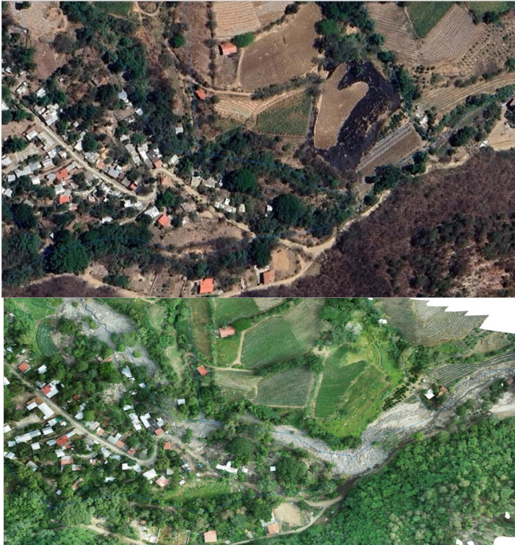
Figura 23. Arrastre y destrucción en el poblado El Jalocote. La imagen superior se obtuvo de Google Earth y la imagen de abajo fue generada utilizando un dron topográfico unos días después del evento.
