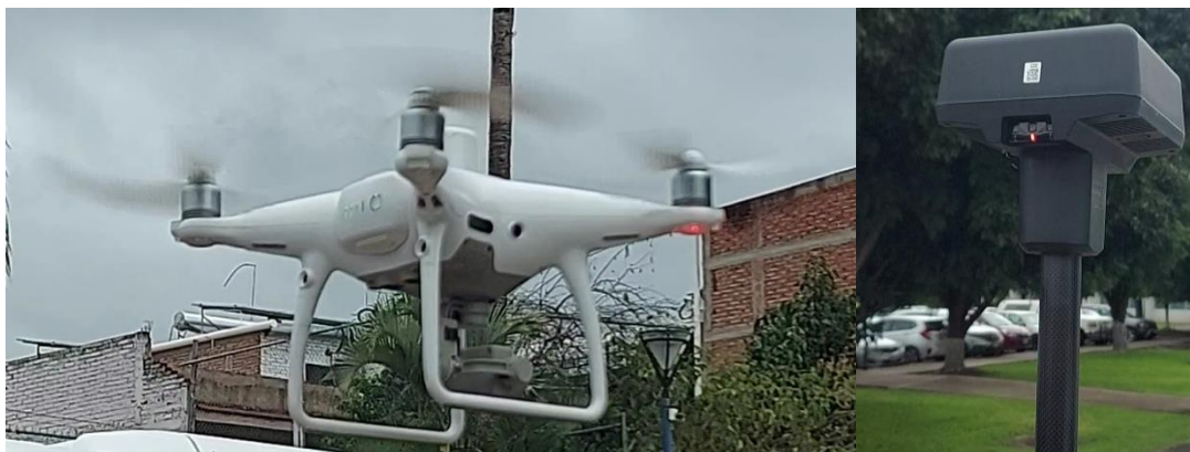
Figura 14. Dron Phantom 4 y estación móvil RTK.
